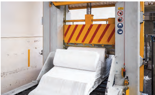
Die Spaltanlage zerkleinert Substratrollen zu Stapel, deren Breite zwischen 20 und 80 Zentimeter variiert werden kann.
