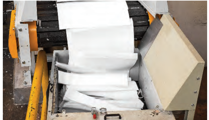
In einem geschlossenen System übergibt ein Förderband die Stapel der Rolle nach dem Spaltvorgang an einen Schredder mit anschließendem Granulator.
