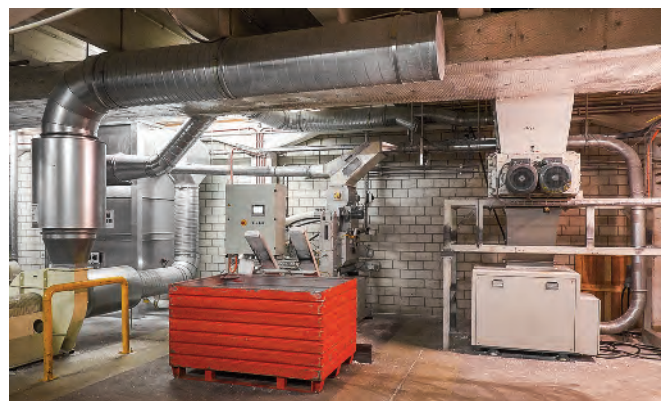
Das Endprodukt des Zerkleinerungsprozesses sind kleine Partikel, die in einer Presse (Bildmitte) zu Briketts verdichtet werden.
