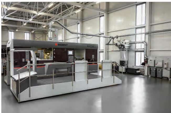
Für das Entsorgen der Produktionsrückstände auf den Folienprägemaschinen von Bobst hat die Hunkeler Systeme AG eine spezielle Absaugtechnik entwickelt.
